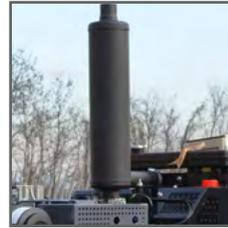
**Глушитель** включен в стандартную комплектацию, снижает шум выхлопа
