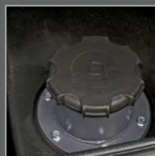
**Заливная горловина топливного бака**
